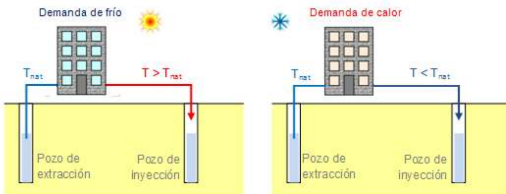
Figura 4. Sistema geotérmico de bucle abierto en una dirección, para calefacción y refrigeración.
